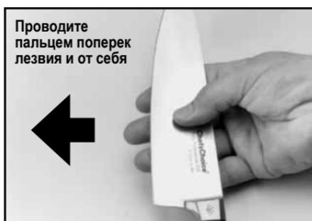
Рисунок 5. Заусенец можно определить, проводя пальцами поперек лезвия и от себя. Осторожно! См. текст.
