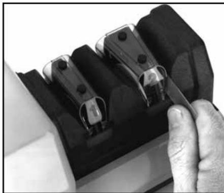
Рисунок 9. Очистка полирующих дисков Устройства 2.
